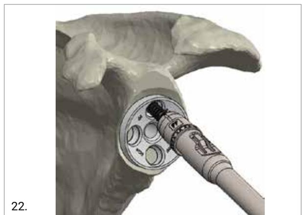
Eindrehen der Schraube bis sich der Schraubendreher vom Schraubenkopf löst und der Schraubenkopf komplett in der Auflagefläche der Basisplatte versenkt ist.
